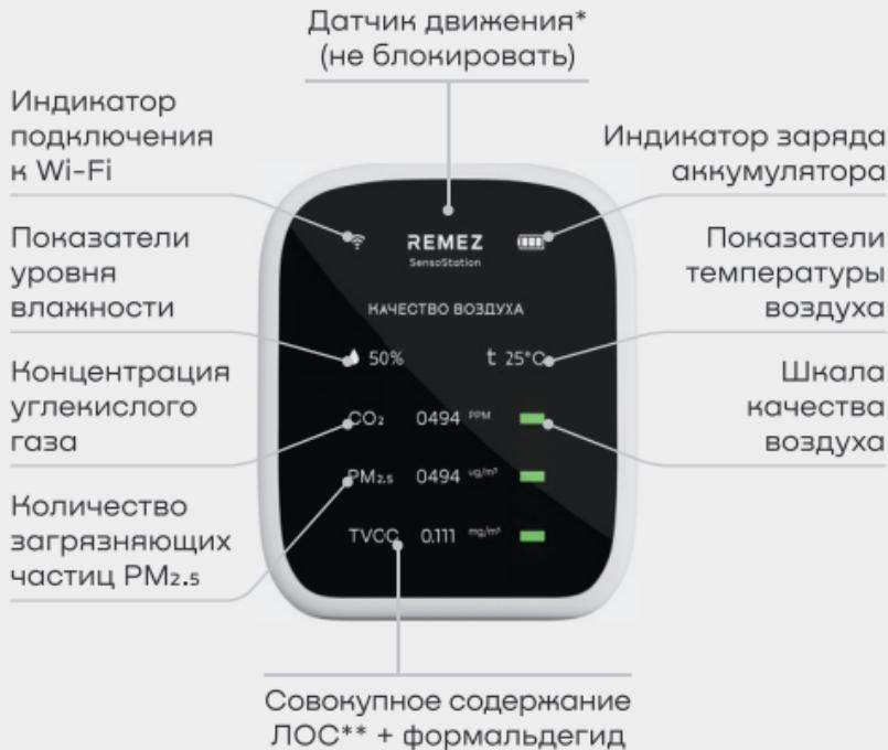
Обновление данных производится в режиме реального времени и обновляется на дисплее каждые 5 секунд.
